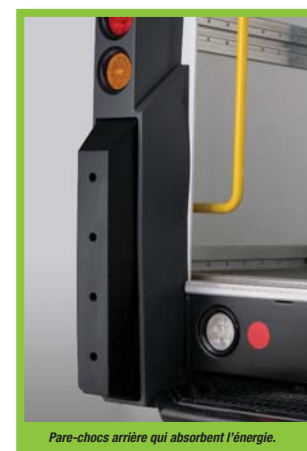
Pare-chocs arrière qui absorbe l'énergie.
