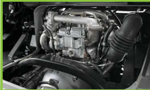
Accès au moteur à partir de la cabine.
